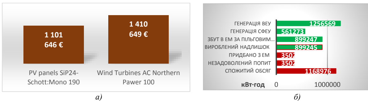
Рис. 2 – Модельні розрахункові дані: а) капітальні витрати на облаштування KEU за проектом; б) – річний розрахунковий баланс KEU, в кВт·год/рік
